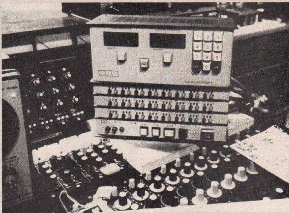
Système « auto locator » destiné à localiser 1 titre sur 24 pistes.
