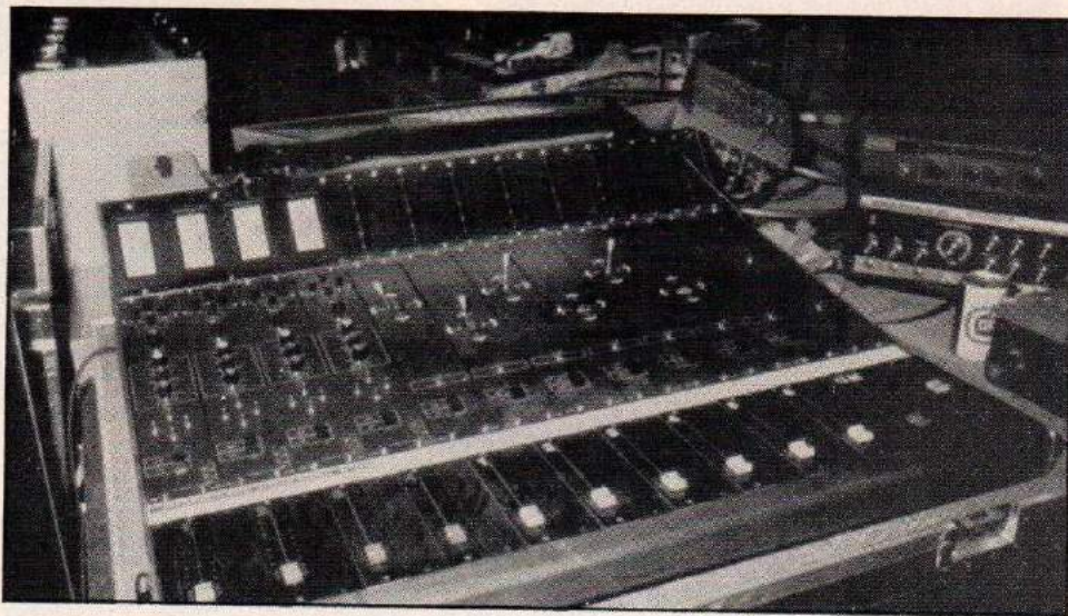
6) Console Midas quadriphonique : dernier mixage avant le départ vers les amplificateurs.
